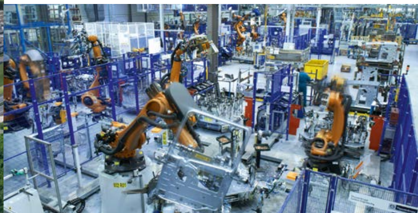
De site van DAF in Westerlo. DAF werkt met robotische puntlastangen.
